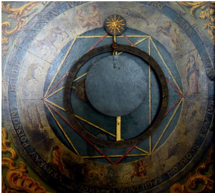
FIGURE 18 – Le disque cachant la lune au moment où le soleil est positionné vers le haut. Ce disque doit avoir son centre fixe sur l'aiguille portant le soleil, et non pendre comme il le fait actuellement. (source : communication de Marc Sauget)
