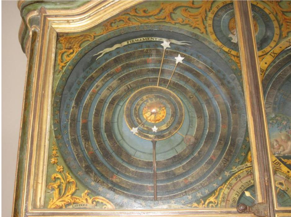
FIGURE 5 – Le planétaire. Les orbites sont toutes circulaires autour d'un même axe (mais évidemment pas concentriques), contrairement aux apparences, parce que les plans de Mercure et Vénus sont plus en avant que les autres. La barre verticale inférieure est un élément du pont permettant de fixer les rouages de Mercure et Vénus.
