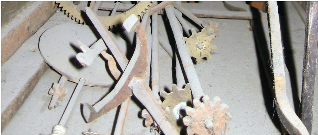
FIGURE 16 – Quelques uns des éléments traînant au sol dans l'horloge. On distingue l'ancre, la lentille du pendule et quelques arbres de transmission. (source : communication de Marc Sauget)
